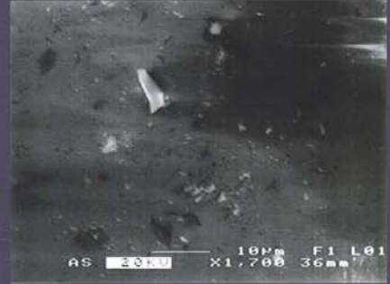
Resim 6: kapalı ve yoğun yapıya sahip, AF ile işlem görmüş beton
